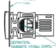
Контроллер XR06CX должен монтироваться на вертикальной панели в вырез 29x71мм и закрепляться, используя поставляемые специальные держатели.
